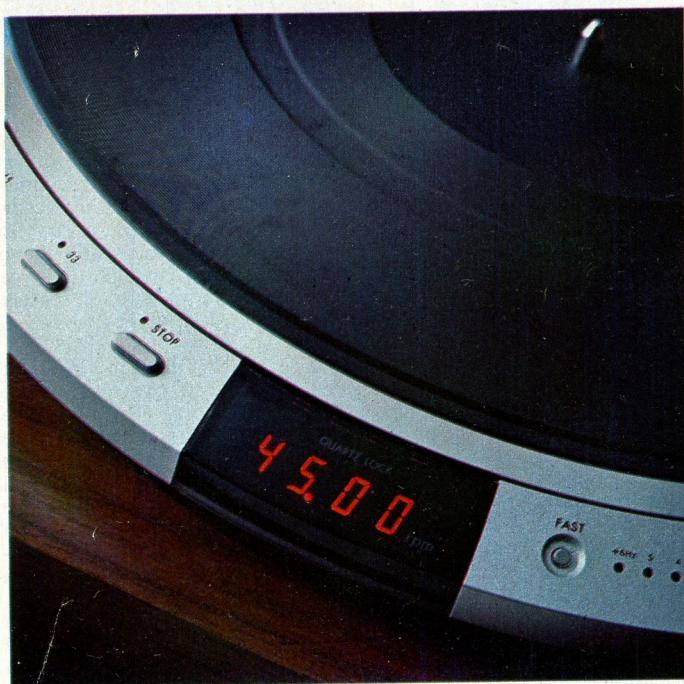
Il contatore del QL-10 conta tre cifre decimali e ne indica due, con l'ultima cifra arrotondata.
